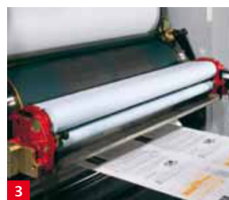
3 Dispositif de lavage des blanchets Les blocs-formats sont préparés en usine pour le montage de laveurs.
