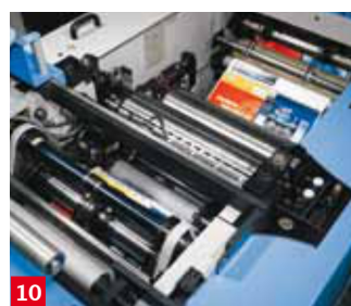
10 Unité de façonnage Le système de calage rapide et le positionnement automatique pour l'impression assurent des temps de calage réduits.
